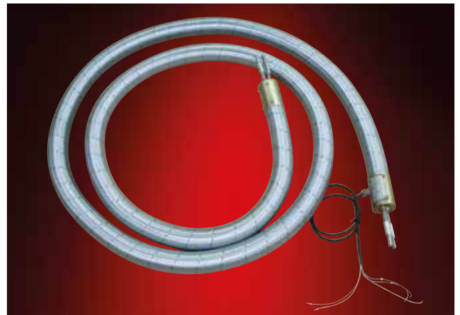
型号: ELH/2adT-150 °C-NW8/10 分析加热软管带有两个内衬层 其管道内径8/10 带有不易破碎的金属波纹软管工作温度范围: 150 °C
