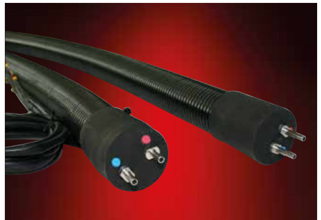
ELH/2aw-200 °C-NW6, 分析加热软管带有2成内衬层, 上述内衬层的管道内径为6/8, 制造内衬层的材料为PFA & 双侧无过渡的特殊的RSL软管接头工作温度范围 200 °C
