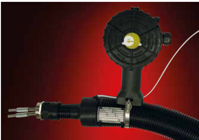
特殊的分析加热软管 类型 ELH/2adsbw-100 °C- NW6/8-EX-SP 用于防爆区域带有2层内衬层, 上述内衬层采用PTFE制成, 其管道内径为6/8,并配有防爆接线端箱, 类型 -Ex-it-R。工作温度范围: 100 °C
