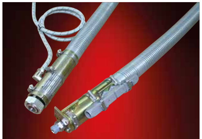
ELH-hdT 200 °C, NW 16 带有作为外护套的金属波纹软管的加热耐压软管是一款不易破碎的产品, 该款产品带有具有其他功能的, 配置在主管道旁的附加管道和特殊的末端盖; 应用: 沥青设备
